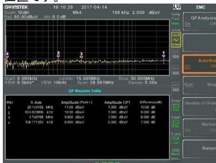
17. トレースはスキャンが実行されるたびに 1 回更新されます。トレースピークが再びリフレッシュされ、QP 周波数設定とアンプ値の取得が実行されます。
