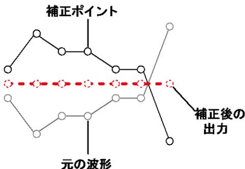
例: 上図は、特定の周波数における損失または利得を補正する振幅補正方法を示しています。
