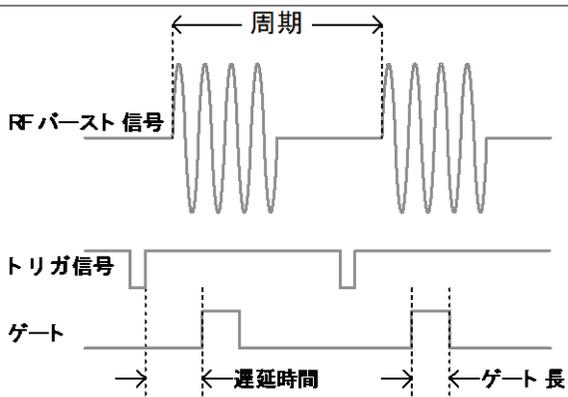
例: 上図は、入力トリガ、入力信号と入力信号に連動したゲートスイープの位置関係を示しています。
