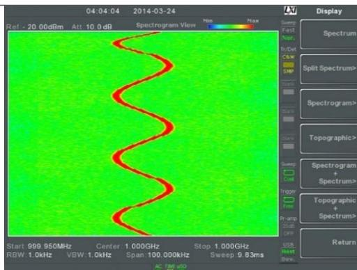
スペクトログラム表示は、周波数ドメインと時間ドメインの両方における信号を表示します。X軸は周波数、Y軸は時間を表示し、各ポイントの色は、振幅レベルを表します（赤色＝レベルが高い、濃い青色＝レベルが低い）。画面上部に最新の新しいトレースが表示され、過去のトレースは、削除されるまで画面下部に向かっていきます。
