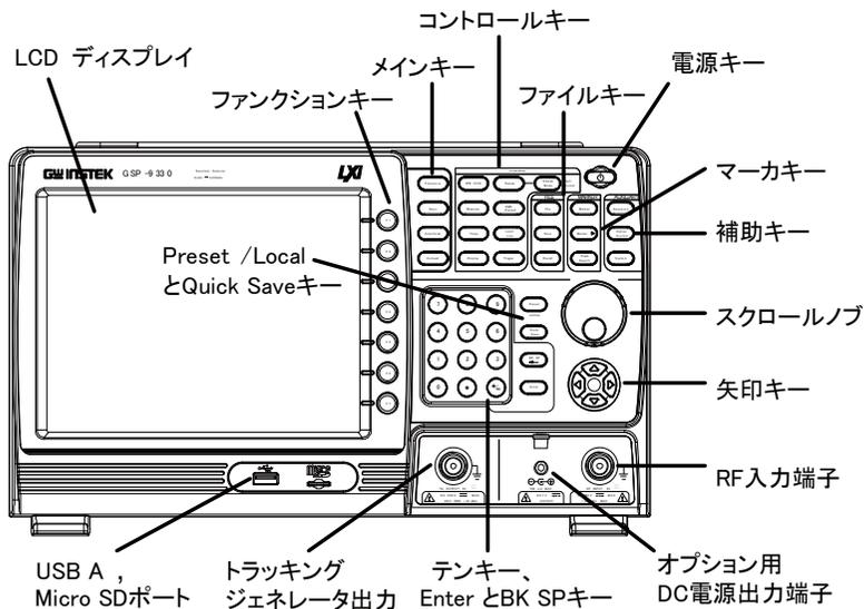
LCD ディスプレイ 8 インチ、SVGA(800×600)カラー液晶を搭載。画面に現在の機能メニュー、振幅とマーカ情報を表示。
