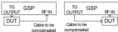
5. 上図のように、**Location[F2]** で DUT の接続場所に従って **PREV** または **POST** を設定します。
